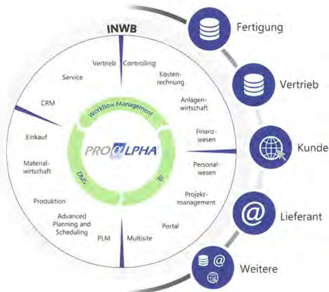
Die Integration Workbench von Proalpha steuert den Datenaustausch mit externen Systemen zentral, anstatt sie über Schnittstellen anzubinden. Das beschleunigt den Datenaustausch und senkt den Wartungsaufwand. Quelle: Proalpha
